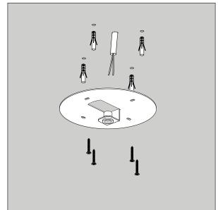
С помощью дюбелей и саморезов (не входят в комплект поставки) установите крепление (поз. 3).
