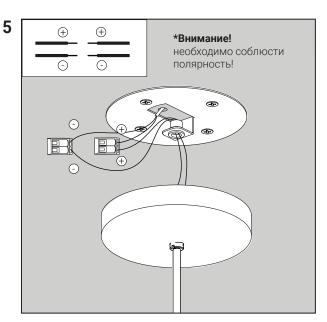
Проденьте кабель светового модуля через ценральное отверстие потолочного крепления. С помощью клемм (поз.6) подключите его к питающему кабелю, соблюдая полярность.
