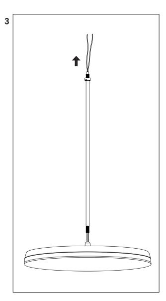
Проденьте кабель светового модуля светильника EVO Move (поз. 2) через штангу (поз. 5) так, чтобы стопорная гайка оказалась сверху.
