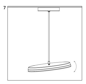
Отрегулируйте наклон светового модуля.
